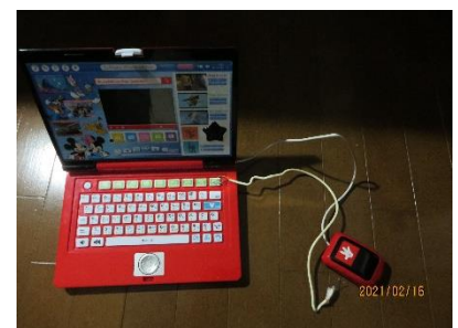
写真3 ワンダフルドリームパソコンのマウスへのケーブルを断線チェッカーを製作し、ケーブル断線箇所を特定、ケーブルを交換修理した
